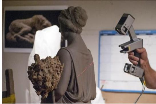
شكل رقم (٦) للمساح الضوئي المستخدم في عملية النحت
