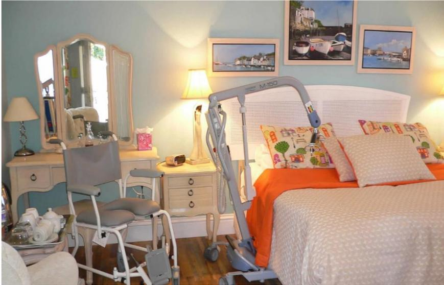
شكل (٤) يوضح استخدام التقنيات المساعدة (الرافعة الهيدروليكية) في التصميم الداخلي لذوي الاحتياجات الخاصة
