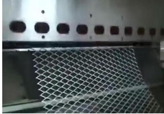
الشكل (٦) يوضح شكل الشبك الممدد بعد الحز و المد
